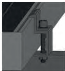
Instalacja zacisku końcowego (opcjonalnie 30/35/40 mm)
